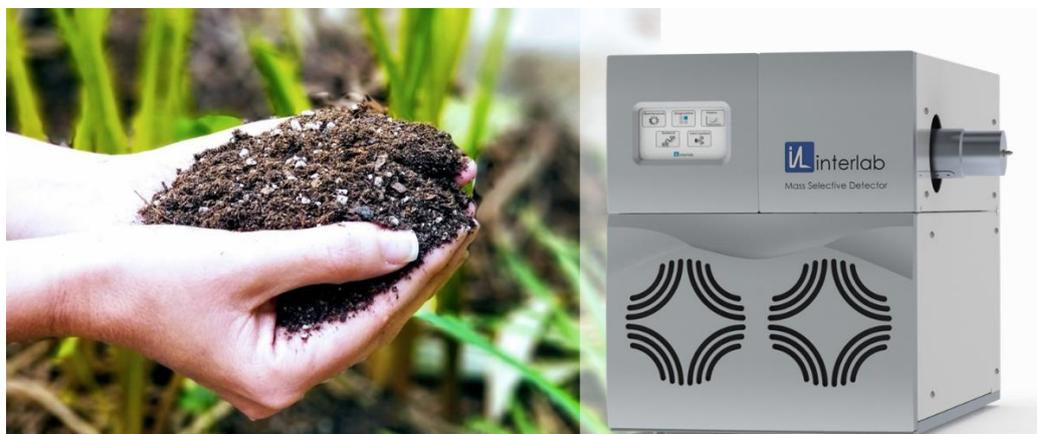
Определение полициклических ароматических углеводородов (ПАУ) в образцах почвы методом пробоподготовки **QuEChERS**, с использованием квадрупольного масс-детектора «**Maestro- $\alpha$ MS**»
