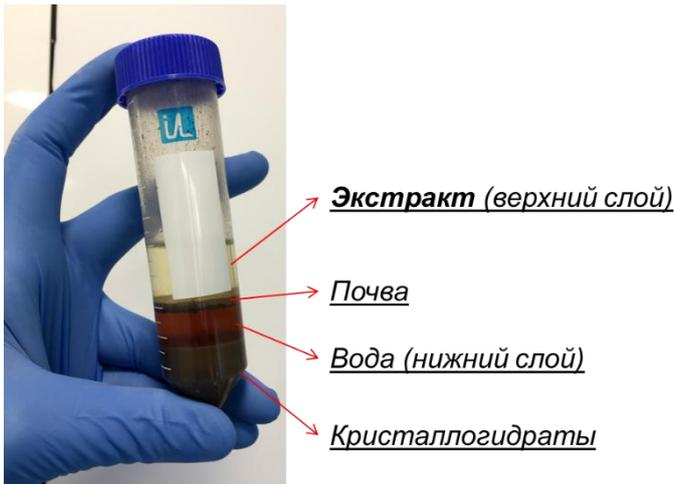
Очистку экстракта осуществляли согласно методики ионообменным сорбентом Bondesil PSA, после чего полученные аликвоты переносили в вialу автосамплера и исследовали методом селективного выделения выделенных ионов (SIM).
