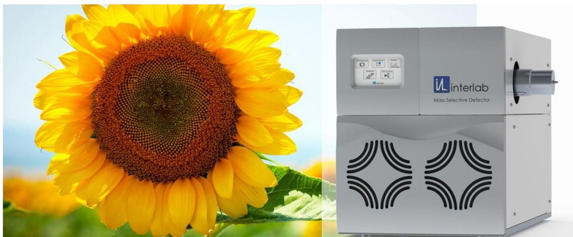
Определение содержания сложных эфиров жирных кислот хлорпропандиолов (MCPD) и 3-бромпропандиола (MBrPD) с применением газового хромато-масс-спектрометра «Маэстро-αMS».
