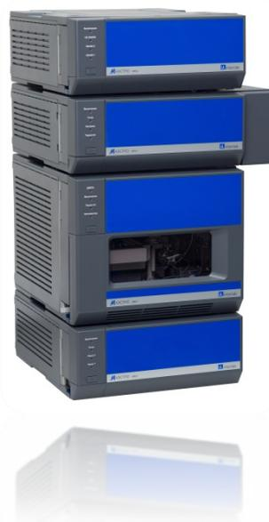
Аналитические возможности жидкостного хроматографа МаэстроВЭЖХ с детектором на диодной матрице и детектором фотометрическим с фиксированными длинами волн (светодиодный) на примере определения 5-гидроксиметилфурфурала в меде в соответствии с ГОСТ 31768-2012 «Мед натуральный. Методы определения гидроксиметилфурфурала»
